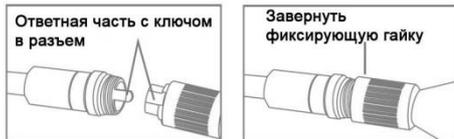
убедиться, что конец трубы с ключом выровнен относительно разъема рукоятки, затем с небольшим усилием соединить их. После правильного соединения завернуть по часовой стрелке фиксирующую гайку до упора.
